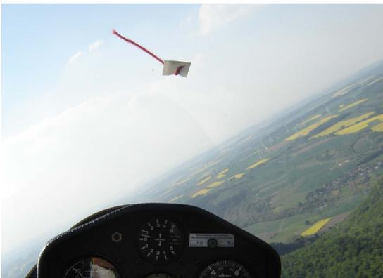
Korrektur: Rechtes Seitenruder mehr treten oder mehr linkes Querruder
