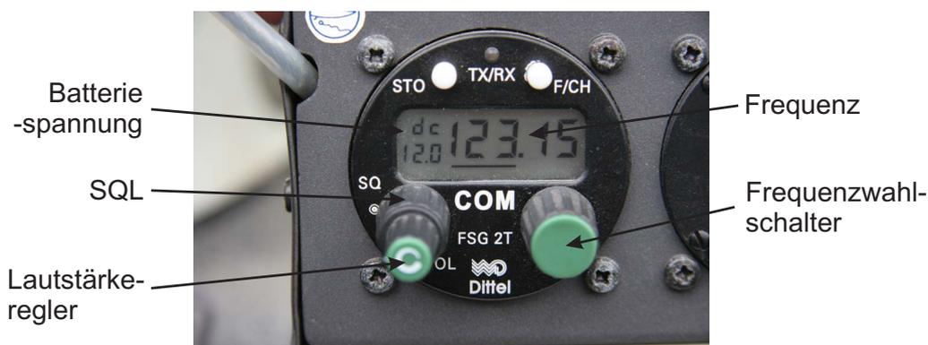
Abbildung 1.7: Funkgerät der DG-1000
