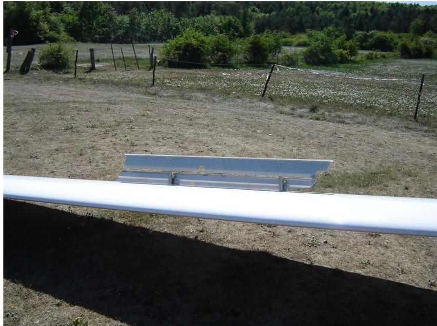
Abbildung 2.8: Ausgefahrene Bremsklappe am Tragflügel
