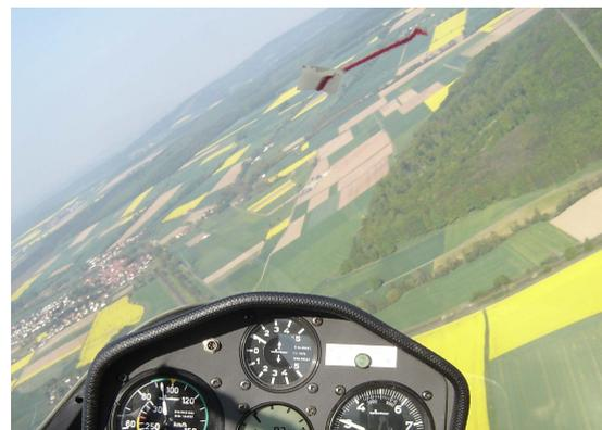
Korrektur: Linkes Seitenruder mehr treten oder mehr rechtes Querruder
