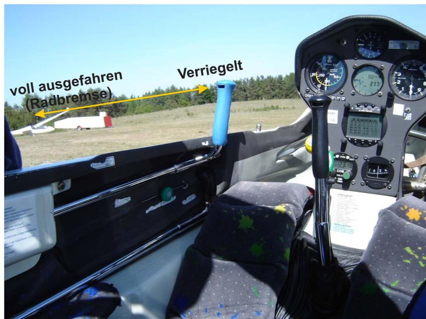
Abbildung 2.7: Bremsklappenbedienung im Cockpit
