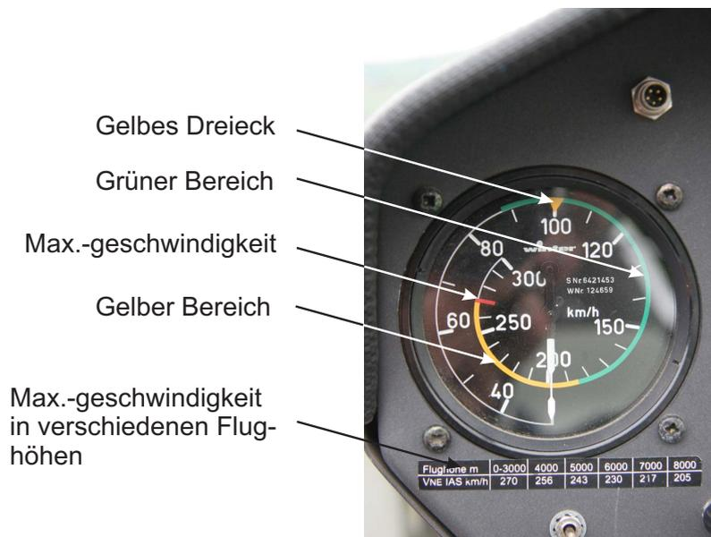
Abbildung 1.2: Fahrtmesser der DG-1000 mit markierten Geschwindigkeitsbereichen
