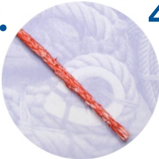
■ Besonders wichtig beim Spleiß ist das "ausdünnen" des Seiles. Das Seil sollte auf einer Länge von ca. 10 cm am Ende ausgedünnt werden (Diese Stelle auf dem Seil markieren). Schneiden Sie aber nur von jedem zweiten Garn etwas ab ! Beginnen Sie von der Markierung aus das erste Garn nach ca. 1 cm abzuschneiden. Beim (über)nächsten nach ca. 2 cm abschneiden usw., bis Sie nach ca. 6 cm jedes zweite Garn abgeschnitten haben.
