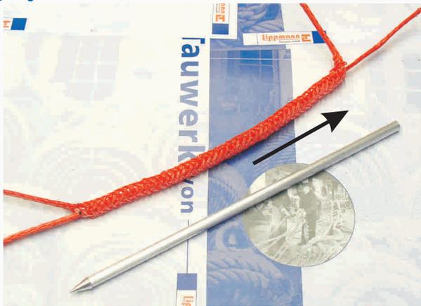
■ Ziehen Sie jetzt den Hoistfid aus der Mitte des ersten Seiles in Pfeilrichtung raus.
