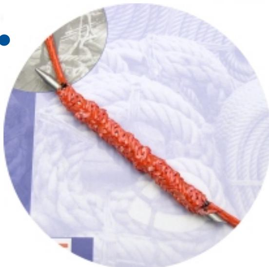
■ Stecken Sie jetzt den Fid an der ersten Markierung in die Seilmitte Richtung zweiter Markierung (Vorher das Seil durch zusammenschieben lockern) und lassen ihn an der zweiten Markierung wieder aus dem Seil rauskommen.
