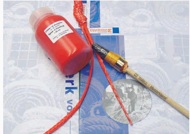
■ Streichen Sie die nun die "ausgespitzten" Seilenden vollständig und reichlich mit Hoistline-Coating ein. Zum Schluss streifen Sie die aufgestauchten Seile jeweils über die "ausgespitzten" Seilenden bis diese in der Mitte vollkommen verschwunden sind. Halten Sie dabei den "Kreuzpunkt" der Seile fest, damit dieser nicht verrutscht.
