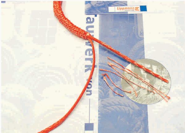
■ Die aus der Mitte heraus schauenden Seilenden müssen nun ausgespitzt werden. Bitte nehmen Sie es immer besonders sorgfältig vor. Beginnen Sie ca. 10 cm vom Seilende aus, jeweils 6 der 12 Garne stufig aus der Hoistline zu schneiden. Stufig bedeutet, dass Sie jeden Schnitt ca. 1 cm in Richtung Seilende versetzen.
