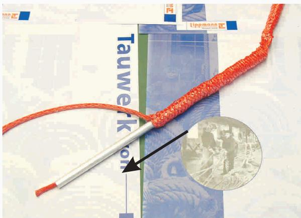
■ Nehmen Sie wieder die Spitze des Hoistfid ab. Schieben Sie das erste Seil in Pfeilrichtung durch den Hoistfid.
