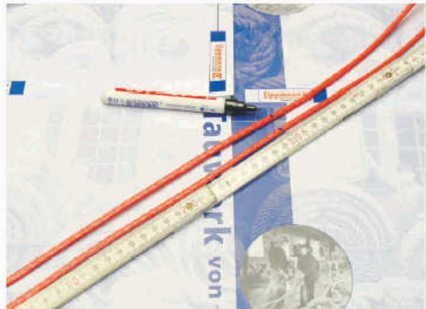
■ Setzen Sie jeweils 30 cm vom Seilende eine Markierung. Eine zweite Markierung setzen sie weitere 35 cm hinter der ersten (also ca. 65 cm vom Seilende).
