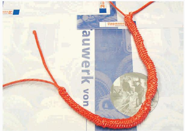
■ Nehmen Sie jetzt die beiden Ende der Hoistline in die Hand, die durch die Mitte des Anderen durchgesteckt wurden und ziehen ruckartig an diesen Ende um den "Kreuzpunkt" der beiden Seile in der Spleißmitte zu "setzen".
