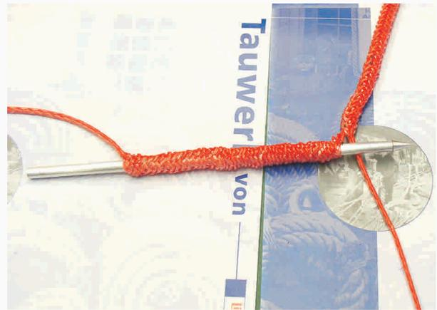
■ Nun stecken Sie den Hoistfid in das zweite Seil. Hier wieder von der zweiten Markierung in Richtung Seilende bis zur ersten Markierung.
