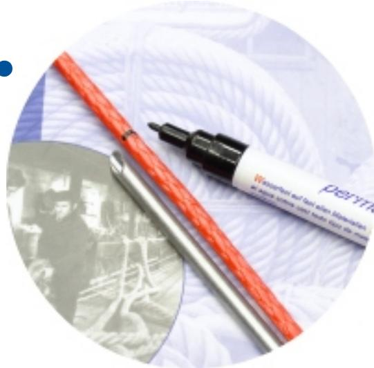
■ Markieren Sie die beiden zu spleißenden Enden wie folgt: Setzen Sie jeweils 19 cm vor den zusammenspleißenden Ende eine Markierung. Dies ist bei Einsatz des Alu-Fids eine ganze und eine kurze Länge des Fid. Eine kurze Länge ist vom Ende des Fid bis zum Doppelstrich auf dem Fid. Eine zweite Markierung setzen Sie ca. 24 cm hinter der Ersten.
